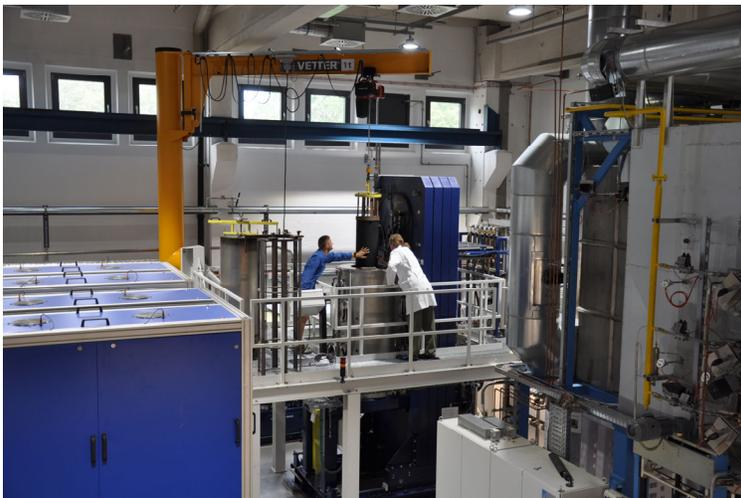
*Ein Kernstück der zahlreichen Anlagen im F&E-Zentrum ist die Heiß-Isostatische Presse (HIP). Hier werden die keramischen Bauteile bei bis zu 2000 °C und 2000 bar thermisch nachverdichtet – ein wichtiger Schritt bei der Erzeugung der Transparenz.
