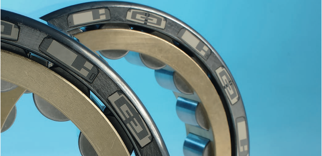
Wälzlager mit aufgedruckten und lasergesinterten Sensoren zur Dehnungs- und Körperschallmessung, realisiert im Rahmen eines Fraunhofer-Verbundprojekts (Quelle: Fraunhofer ILT).
