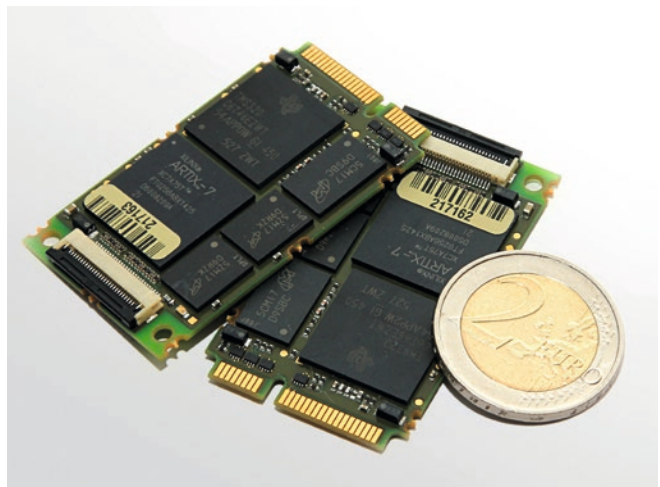
Hardwaremodul zur Mustererkennung.
