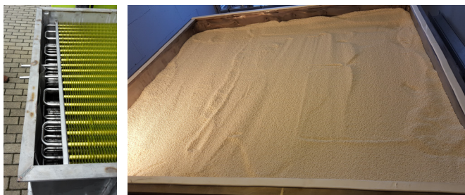
Prototyp eines Zeolith-Wärmespeichers mit 150 kWh Speicherkapazität.
