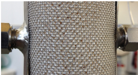
Zeolithgranalien in einem Testaufbau des Fraunhofer IKTS zur Bestimmung der Wärmespeichereigenschaften.
