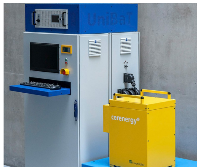
Prüfstand für die Analyse von stationären Batteriemodulen und -systemen.
