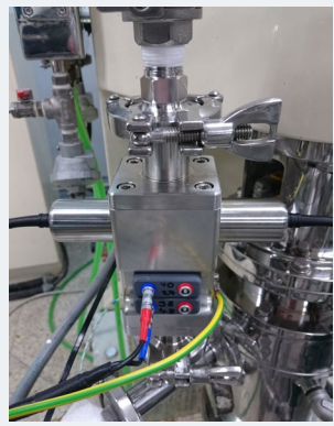
볼밀 장비에 설치된 와전류 및 초음파 프로브
