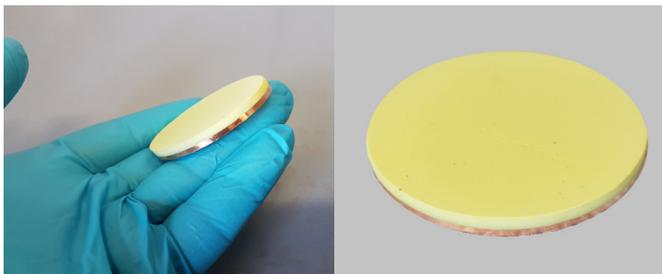
*Cu-gebundenes WO<sub>3</sub>-Sputtertarget vom IKTS für den DC-Sputterprozess (ungebondet für RF-Magnetron-Sputtern nutzbar).*
