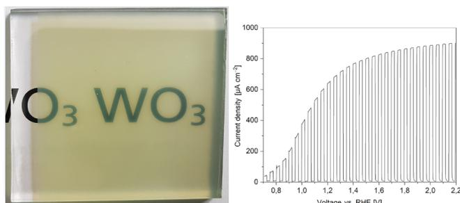
*Mittels DC-Sputtern abgeschiedene, transparente WO<sub>3</sub>-Schicht von ca. 1µm Dicke (links), fotoelektrochemische Aktivität (rechts).*
