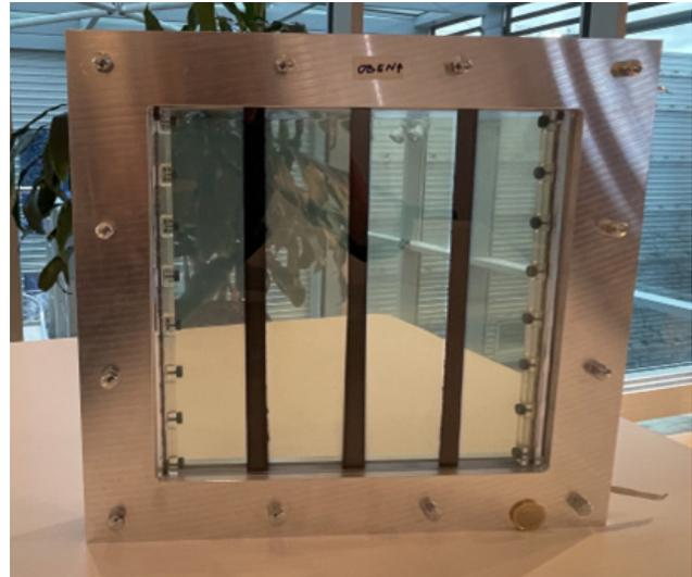
*500 cm<sup>2</sup> Einzelmodul eines autarken PV-PEC-Reaktors.*
