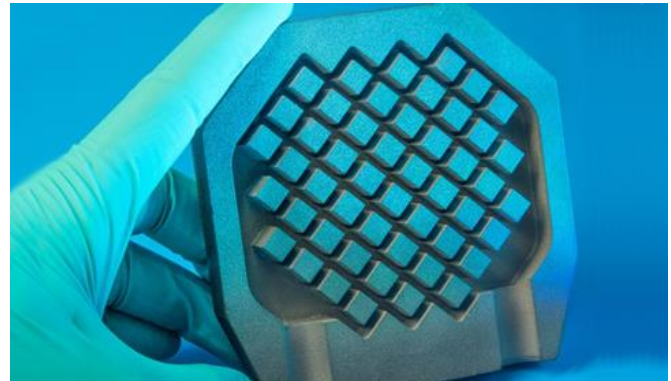
Kühlelement aus SiC-gebundenem Diamantwerkstoff.
